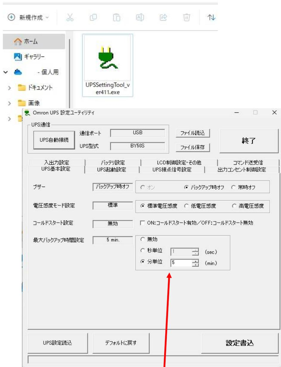
UPS と接続し、基本設定の最大バックアップ時間を 5 分に設定。
